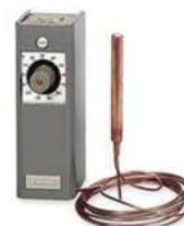
(c) از ترمومتر جهت کنترل دمای آب خروجی از دستگاه و فلوسوئیچ جهت کنترل دبی آب در گردش استفاده نمایید. فلوسوئیچ شدت جریان آب را کنترل می‌نماید و در صورت گرفتگی فیلترها و کاهش جریان آب، وارد عمل شده شیر برقی مدار دیفراست را باز می‌کند. (ترموستات را روی عدد ۷+ سانتیگراد تنظیم نمایید).
